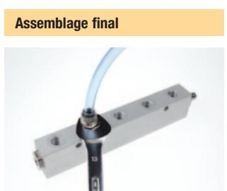
Visser l'écrou à fond, à la main (dans le cas d'un tube souple) et à la clé (dans le cas d'un tube semi-rigide) jusqu'au contact avec le corps.
